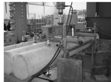
图 12-7 正在加载的模型桩
