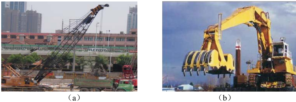
图 23-10 抓铲挖掘机 (a) 钢丝绳抓铲挖掘机 (b) 液压抓铲挖掘机
